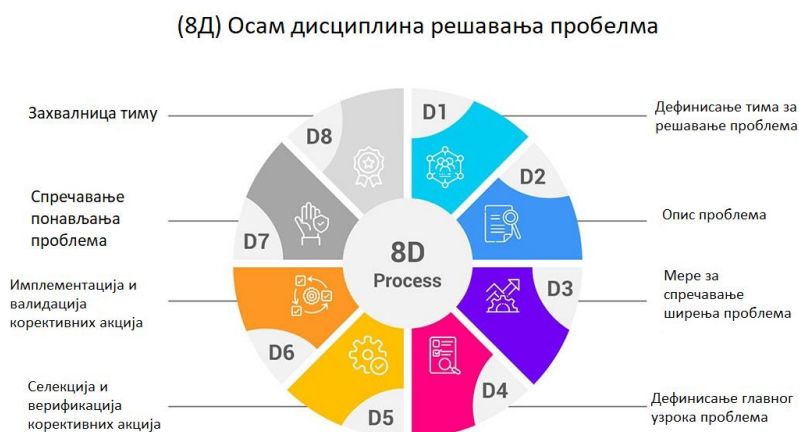
Слика 1. Приказ основних дисциплина које су саставни део 8Д методологије и које су неопходне за креирање 8Д извештаја [3]
