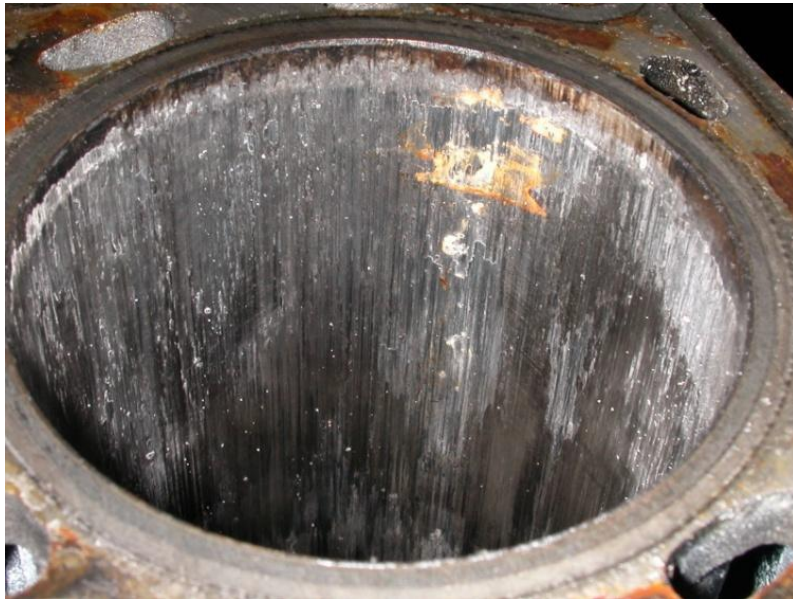
Slika 7. Habanje košuljice cilindra
