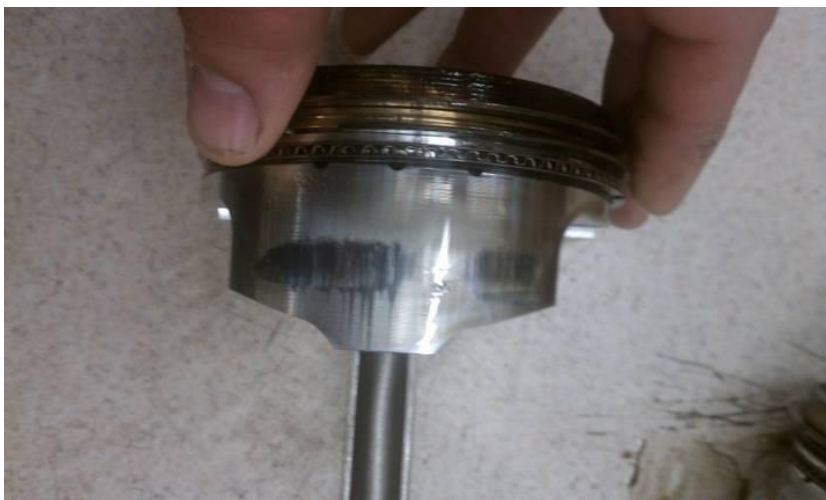
Slika 5. Normalno habanje košuljice klipa
